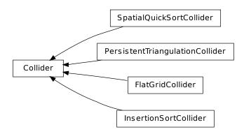
$\textbf{class yade.wrapper.Collider}(inherits\ GlobalEngine \rightarrow Engine \rightarrow Serializable)$
