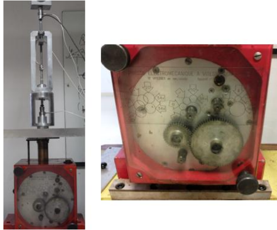
Figure 69 : Montage MATHRYX sur une presse mécanique 2 tonnes
