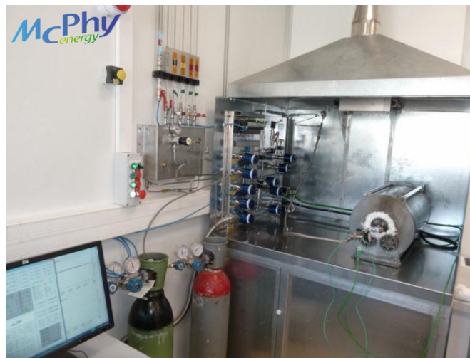
Figure 137 – Photographie du banc d'essai utilisé pour cycler le matériau (Photographie McPhy Energy)
